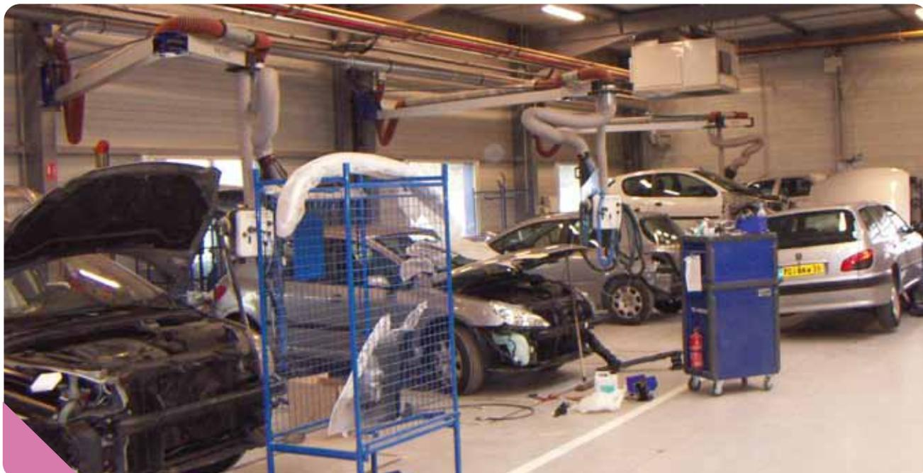
**Atelier carrosserie avec bras d'énergies et de fumée de soudure /
