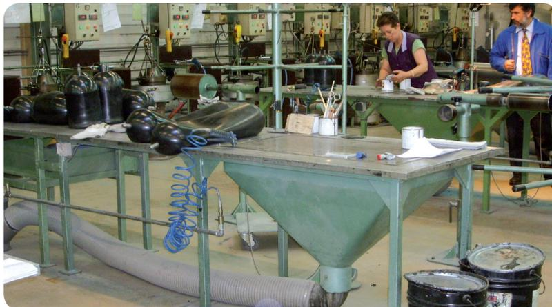
Table équipée d'une aspiration d'émanations / Table equipped with toxic fume aspiration
