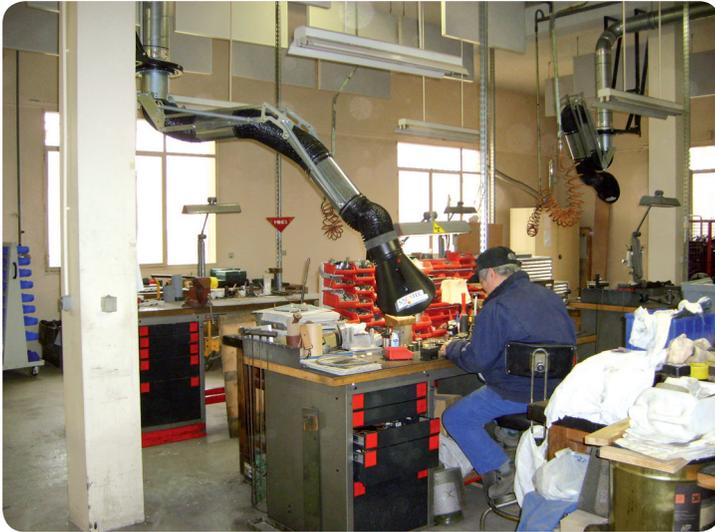
Ventilation sur poste de travail/Ventilation on work place
