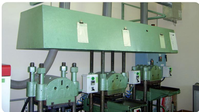
Ventilation pour Presse de moulage / Ventilation for moulding press
