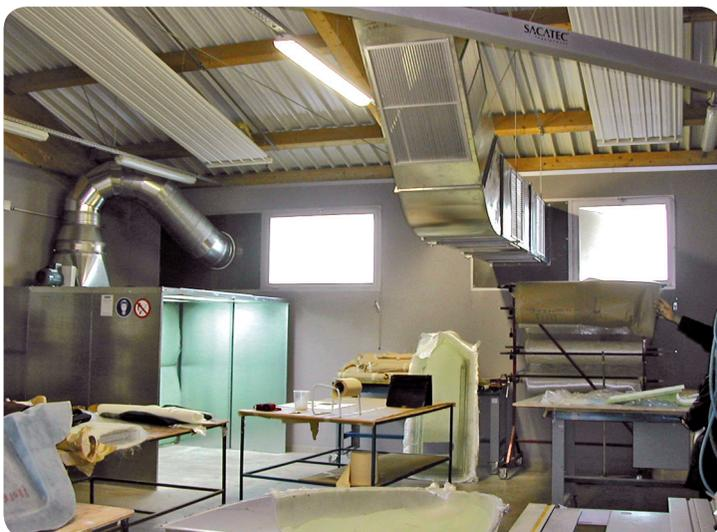
Cabine ouverte avec compensation d'air/Open spray booth with air clearing
